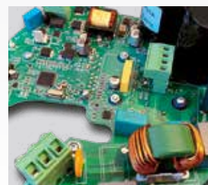
Scheda elettronica di azionamento
